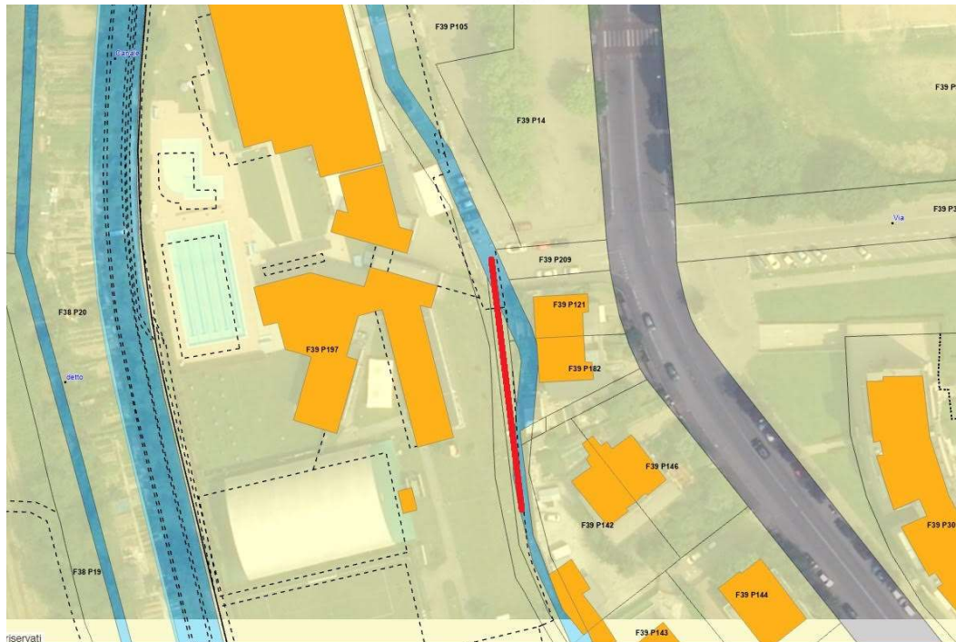
Figura 4 - T. Nirone in via Dante (nei pressi delle case vicino la piscina): il tratto del torrente (in tratteggio nella figura a e in rosso nella figura b) è intubato e deviato rispetto al tracciato della cartografia catastale (puntinato nella figura a e in rosso nella figura b). La modifica del tracciato è stata riportata nelle Tav. 2 e 3 del RIM
